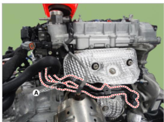
10. 拆卸涡轮增压器歧管模块隔热板 (A)。
